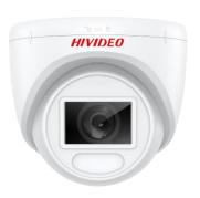
Камера подключается к локальной сети (к роутеру) и электросети 220В через РОЕ адаптер. Запись видео производится на установленную в камере карту памяти MicroSD 128 GB. Этого объема памяти достаточно для непрерывной записи видеоархива в течении 5 суток или около 30 суток при записи по детекции движения в кадре (в зависимости от интенсивности движения). Просмотр живого видео и архива видеозаписей осуществляется через приложения для устройств Android, iOS и Windows.
